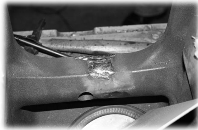
Motorblokk til en Caterpillar V16 sveist med Magna 770 AC-DC
